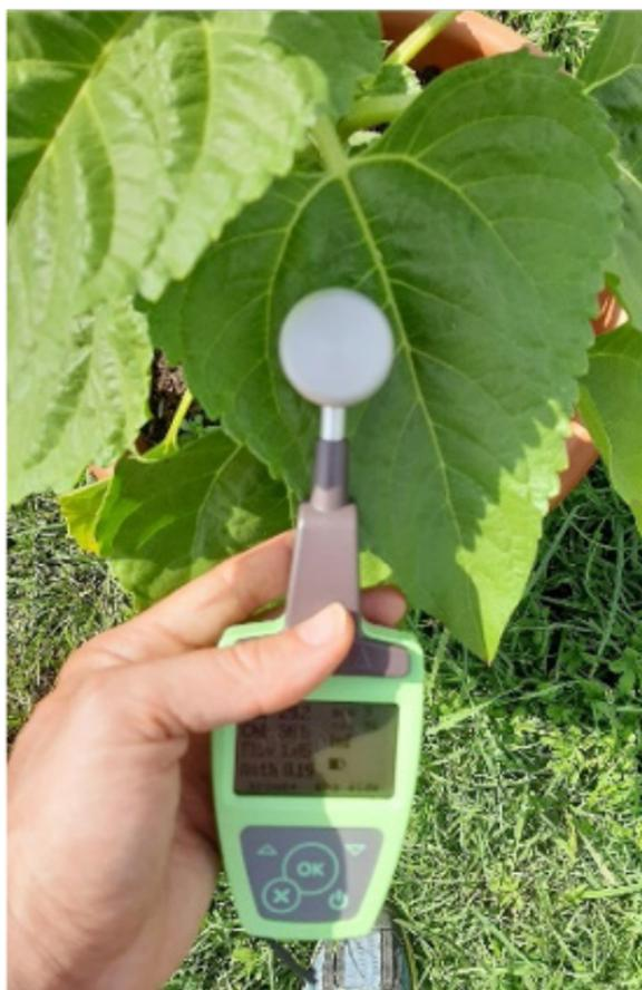
Fig. 2 - Visuale dello strumento Dualex in fase di lettura.
